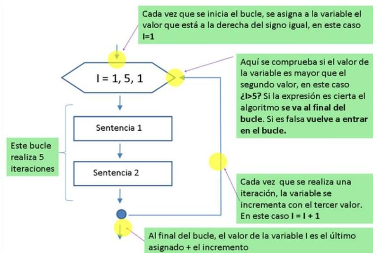
Figura 2. Representación y funcionamiento de un bucle for
