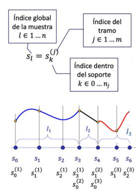
Por ejemplo: tenemos 7 puntos  $s_0, s_2, ..., s_6$  (por tanto l =6) y los distribuimos de la siguiente forma con  $\mathbf{m}$  = 3 intervalos
